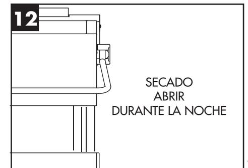
12 Vuelva a armar la máquina y deje abierta la tapa para ayudar a secar durante la noche.
