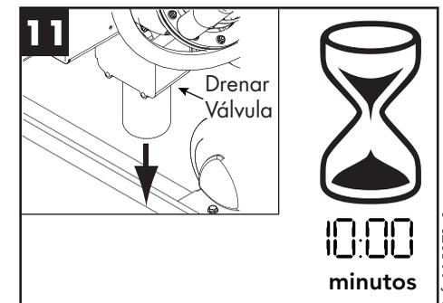
Se abre la válvula de drenaje automático por 10 minutos para drenar la máquina.
