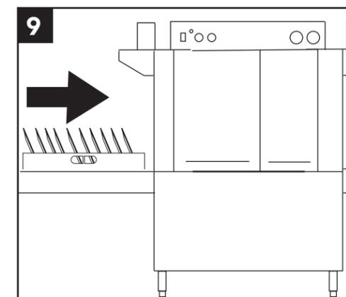
Inserte una rejilla con utensilios en la lavadora de platos. Las bombas y el transportador funcionarán.
