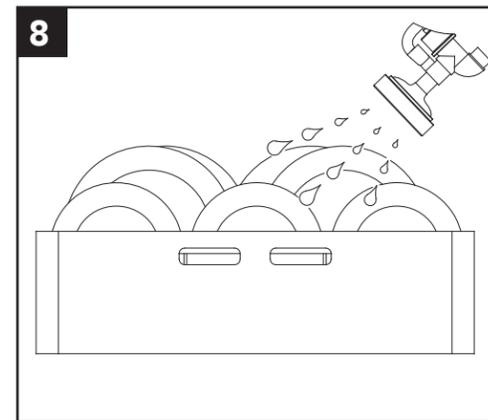
Raspe previamente y cargue los utensilios en las rejillas de platos. Los platos y vasos van en la rejilla con clavijas, las tazas y los tazones van en una rejilla plana. Ponga los cubiertos en una sola capa en una rejilla plana.
