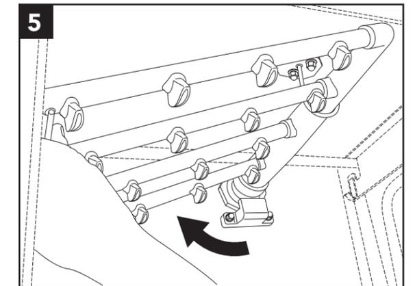
Retire los ensamblajes del brazo de lavado superior y lávelos dentro de un fregadero.
