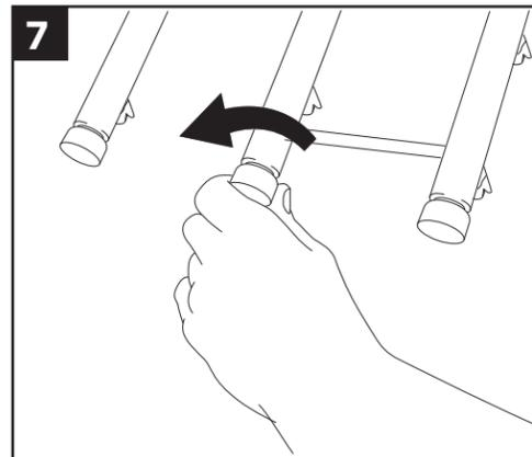
Retire los tapones de los extremos en cada brazo de lavado y limpie bien las tuberías.
