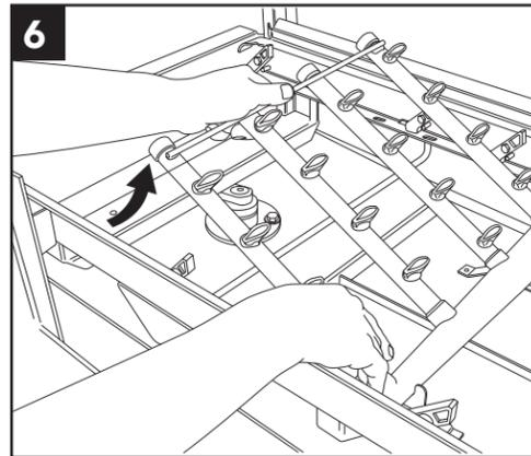
Retire los ensamblajes de brazos de lavado inferiores y lávelos dentro de un fregadero.
