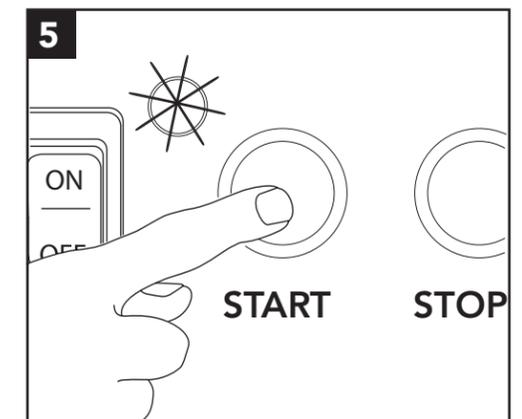
Pulse el interruptor START [Arranque]. La luz verde se ilumina. La máquina se llena con agua y el calor del tanque se enciende.
