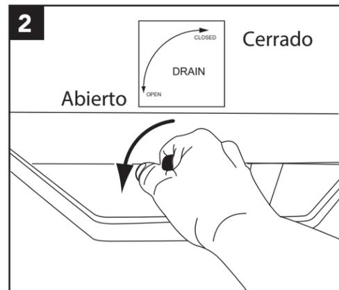
Gire la manija del desagüe hacia la izquierda a la posición vertical para drenar los tanques.
