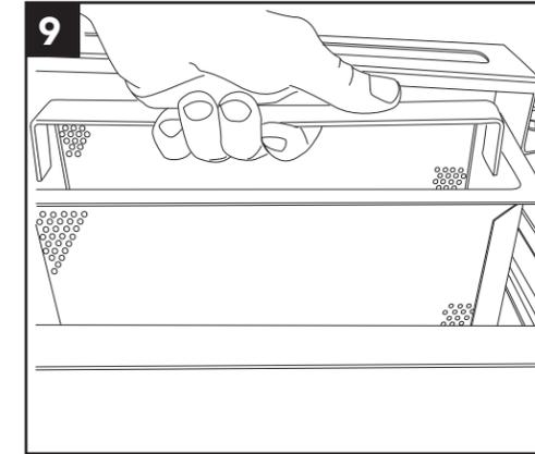
Retire las mallas de residuos y lave en reversa dentro de un fregadero. No golpee las mallas sobre superficies duras.
