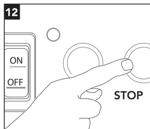
Pulse el botón STOP [Parada] para detener las bombas y la transmisión. Se apaga la luz verde. Pulse el interruptor START [Arranque] e inserte una rejilla de platos para reanudar la operación.
