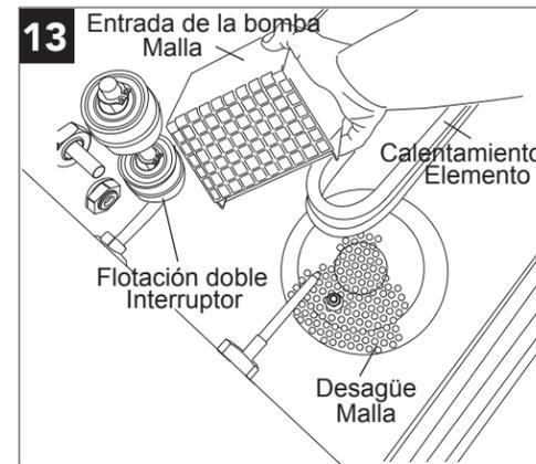
Retire la malla de entrada de la bomba y lávela dentro de un fregadero. Revise y limpie el interruptor de flotación doble, el elemento calentador y la malla de desagüe.
