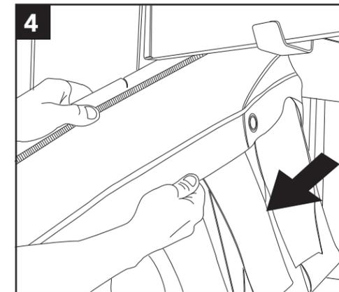
Retire los ensamblajes de cortinas y enjuague bien dentro de un fregadero.
