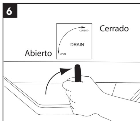
Si se abre el desagüe o el llenado funciona más de 10 minutos, se apaga la lavadora de platos y parpadea la luz verde encendiéndose y apagándose. Cierre el desagüe o revise el llenado, luego apague el interruptor de encendido y enciéndalo de nuevo para restablecer el funcionamiento. Pulse el interruptor Start [Arranque] para reanudar la operación.
