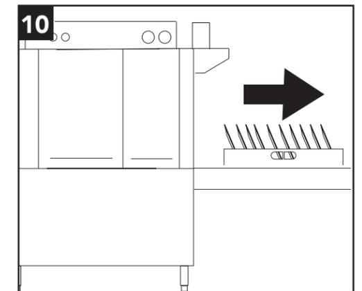
La lavadora de platos bombea y la transmisión funciona 90 segundos después de que la rejilla entre en la máquina. Si se cargan rejillas adicionales antes de que salga la primera rejilla de la máquina se restablece el temporizador.
